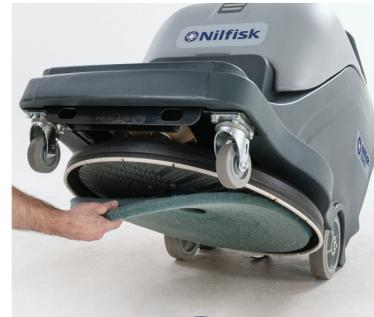
5. Снимите пад и проверьте состояние. При необходимости замените его. Обязательно используйте правильный пад в зависимости от типа пола и области применения
