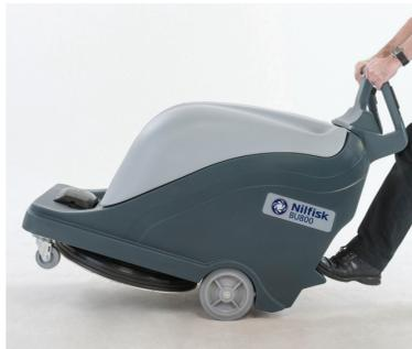
3. Наклоните машину, чтобы получить доступ к фиксатору колодки
