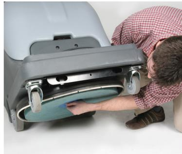
4. Поверните фиксатор и извлеките его из машины
